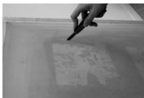
(3) イメージより大きめにシルクの紗をカッターで切り落とす
